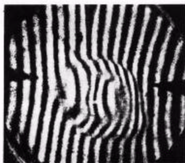
图3 (23/0/80) 序列在主压缩磁场的第一个半周期内的干涉图的照片。
