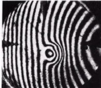
图4 (23/-\frac{5}{5.6}/80) 序列在主压缩磁场的第一个半周期内的干涉图的照片。
