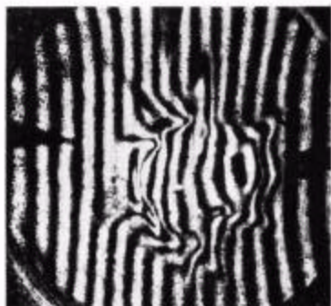
图3 (23/0/80) 序列在主压缩磁场的第一个半周期内的干涉图的照片。
