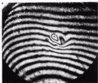
图3 (23/0/80) 序列在主压缩磁场的第一个半周期内的干涉图的照片。
