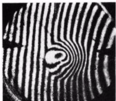
图4 (23/-\frac{5}{5.6}/80) 序列在主压缩磁场的第一个半周期内的干涉图的照片。
