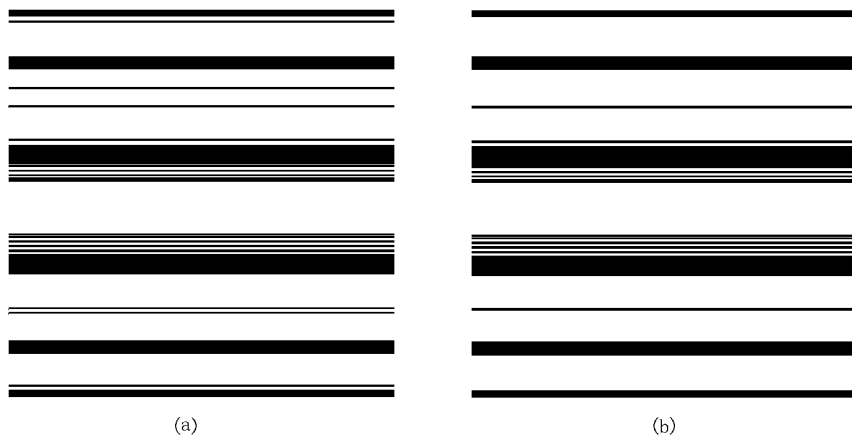
图7 单电子(a)和双电子(b)掺杂时 -(\text{PtCl})_{10}-(\text{PtBr})_{10}- 系统的能谱
