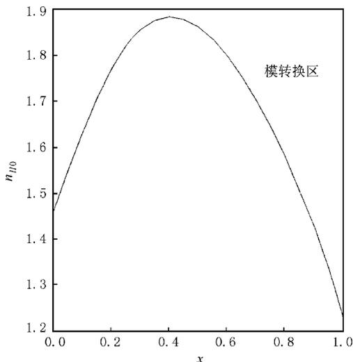
图2 模转换点的位置 对应参量为  $n_c(x) = 1 \times 10^{13} \text{ cm}^{-3} \times (1 - 0.9x^2)$ ;  $q(x) = 1 + 2.5x^2$ ;  $B = 2.5 \text{ T}$ ;  $f = 2.45 \text{ GHz}$
