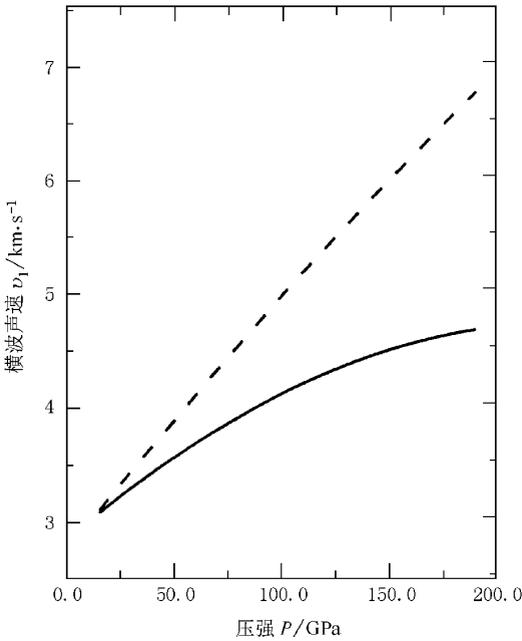
图 2  $G_p'' = -0.033 \text{ GPa}^{-1}$  (实线) 与  $G_p'' = 0$  (虚线) 时的横波声速  $v_t$  的计算结果比较
