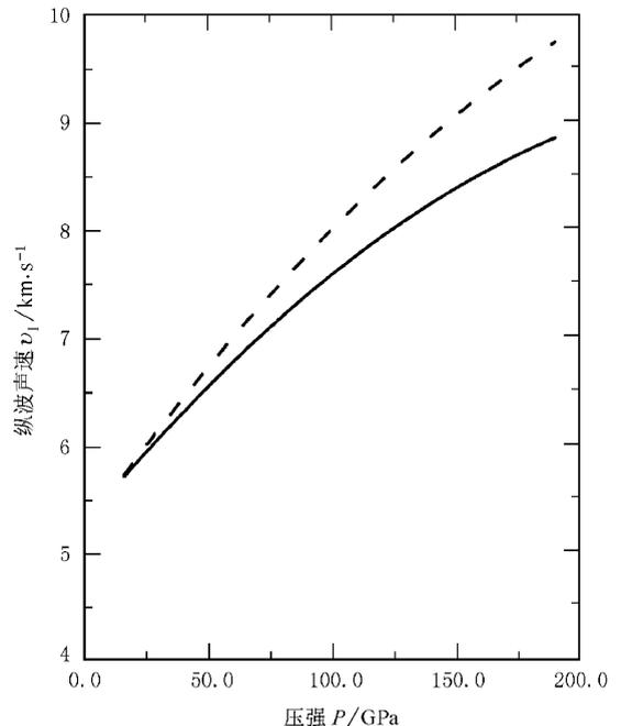
图 1  $G''_P = -0.033 \text{ GPa}^{-1}$  (实线) 与  $G''_P = 0$  (虚线) 时的纵波声速  $v_l$  的计算结果比较
