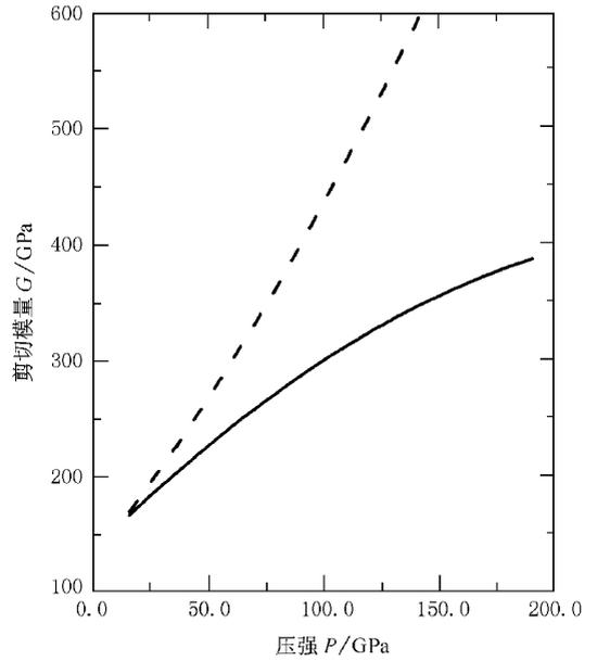
图 3  $G_p'' = -0.033 \text{ GPa}^{-1}$  (实线) 与  $G_p'' = 0$  (虚线) 时的剪切模量  $G$  的计算结果比较
