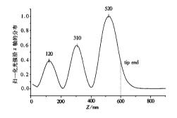
图 3 光强沿光纤探针中心轴的分布图
