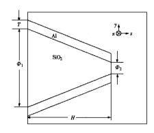
图 1 光纤探针的三维 FDTD 计算模型
