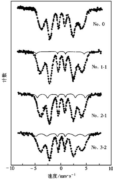
图 1 电脉冲处理前后部分试样穆斯堡尔谱
