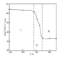
图 3 岛的平均尺寸随基底温度的变化
