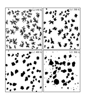
图 2 不同基底温度时岛的形貌( $\theta = 0.15 \text{ ML}$ )
