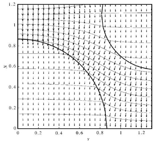
图3  $x=0.5$  平面上的等势线和电场, 参数同图1
