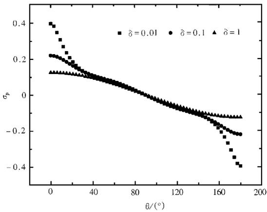
图 4 不同  $\delta$  时表面电荷随  $\theta$  角的变化 ( $\varphi = 0^\circ$ ), 参数同图 1
