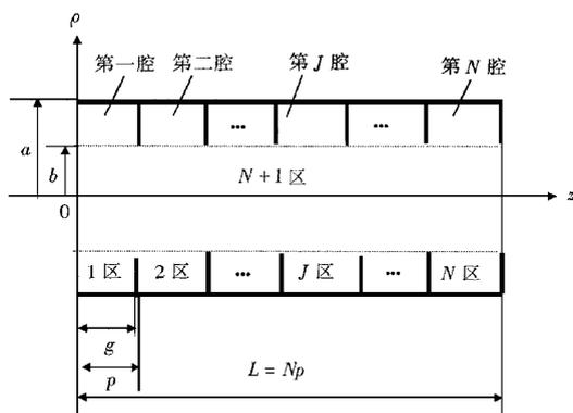
图 1 整腔结尾的  $N$  腔谐振腔链的结构示意图
