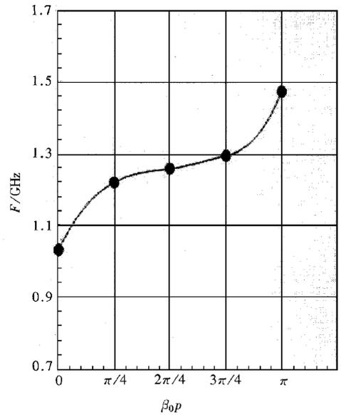
图2 四腔渡越管  $TM_{010}$  模的色散曲线
