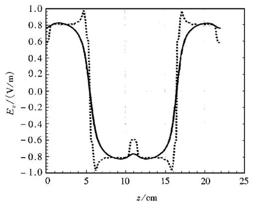
图8  $2\pi/4$  模  $E_z$  场  $R=3.2, 3.9$  cm 处的轴向分布图 图注同图4
