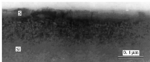
图 6 50\text{kV} , 4 \times 10^{17}\text{ ions/cm}^2 样品未退火的截面电镜形貌像
