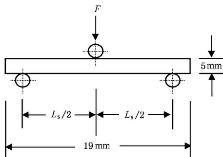
图 1 三点弯曲试验示意图
