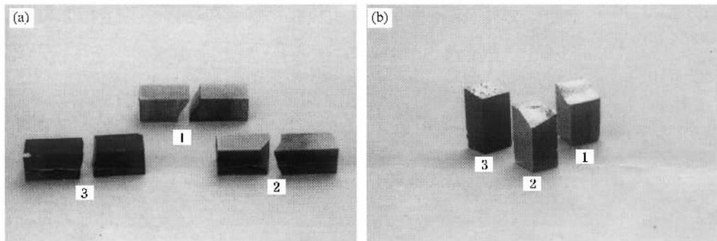
图 2 不同取向方向试样的典型宏观断口形貌 ( $\times 1$ ) 1 2 3 分别为沿 5mm 6mm 和 19mm 方向取向试样的典型断口)
