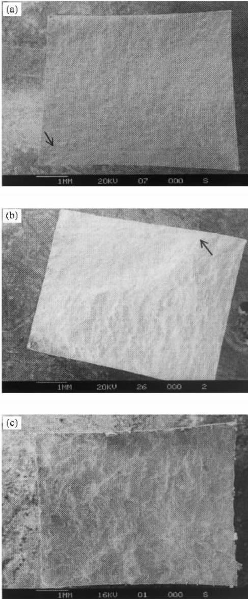
图 3 低倍下不同取向方向试样的典型断口形貌 (a) (b) (c) 分别为沿 5mm、6mm 和 19mm 方向取向试样的典型断口)
