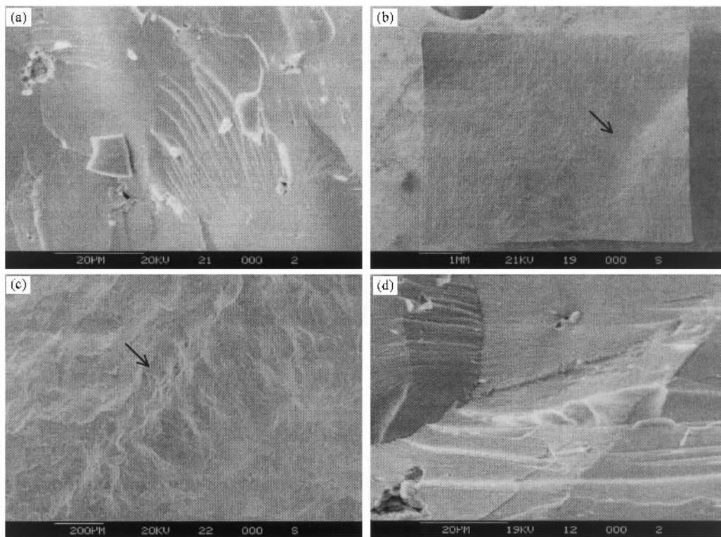
图4 合金解理断裂的微观形貌 (a)典型的解理形貌 (b)低倍下,沿 6mm 方向取向试样的典型断口形貌 (c)图(b)的局部放大——“麻花状”形貌 (d)沿 6mm 方向取向的试样,其解理裂纹沿不同的面和方向扩展
