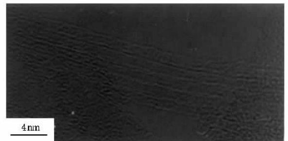
图 2 单壁碳纳米管捆的高分辨电镜照片
