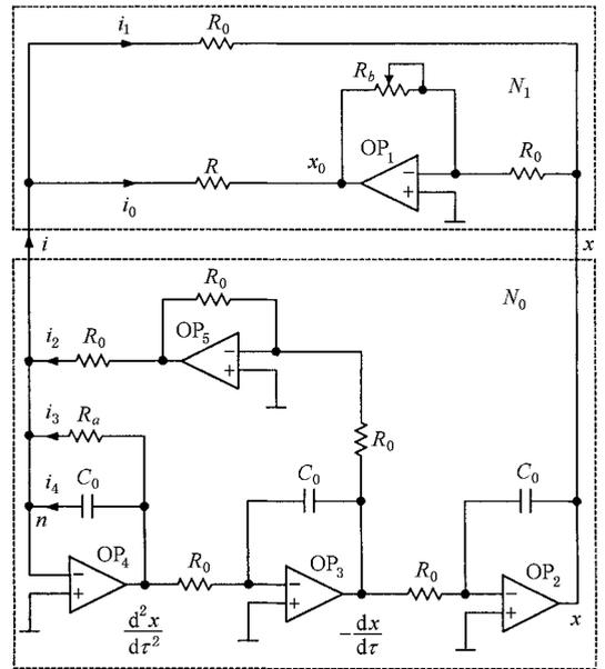
图 2 用  $\alpha$  值可变的三段线性奇函数构成混沌电路
