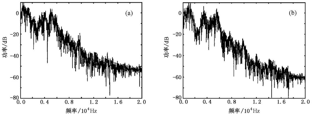
图 7 单层双螺旋、双层双螺旋混沌吸引子的功率谱 (a) 单层双螺旋功率谱 (b) 双层双螺旋功率谱
