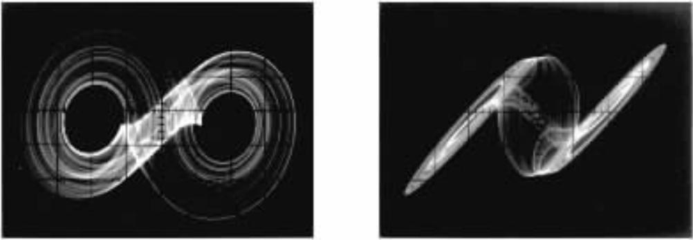
图 15 单层双螺旋混沌吸引子电路实验结果(  $50 \text{ k}\Omega < R_0 < \infty$  )
