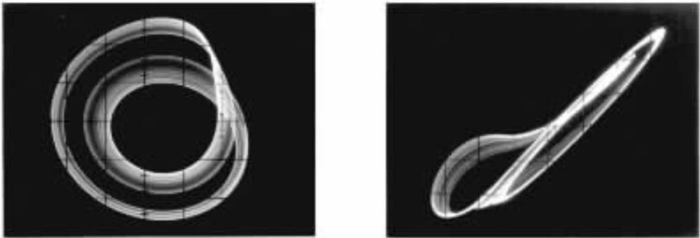
图 12 双层单螺旋混沌吸引子电路实验结果(  $27 \text{ k}\Omega < R_0 < 30 \text{ k}\Omega$  )
