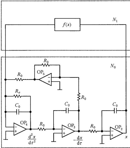
图 1 单层单螺旋、单层双螺旋混沌电路
