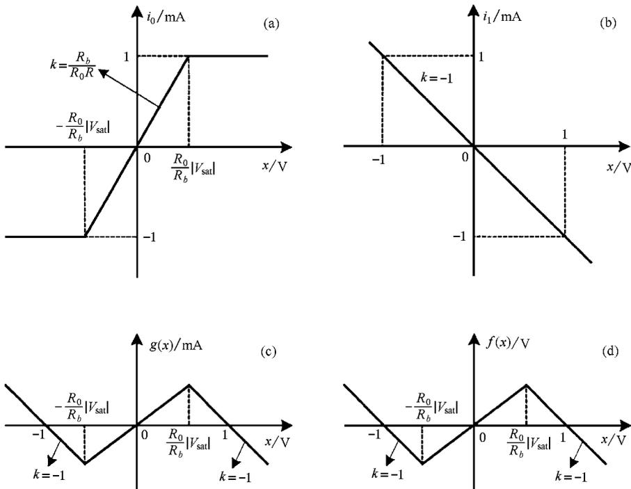
图 4 用子电路  $N_1$  产生  $f(x)$  的形成过程 (a)  $i_0$ - $x$  伏安特性 (b)  $i_1$ - $x$  伏安特性 (c)  $g(x)$ - $x$  伏安特性, (d)  $f(x)$ - $x$  电压传输特性
