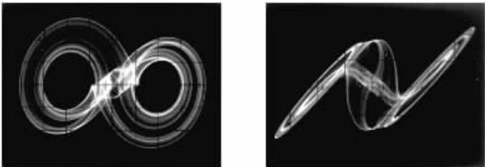
图 14 双层双螺旋混沌吸引子电路实验结果(  $36 \text{ k}\Omega < R_0 < 42 \text{ k}\Omega$  )
