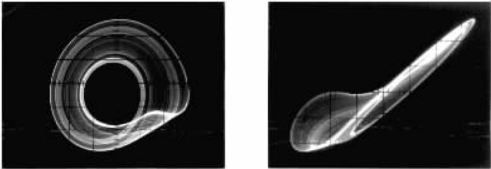
图 13 单层单螺旋混沌吸引子电路实验结果(  $30 \text{ k}\Omega < R_0 < 32 \text{ k}\Omega$  )
