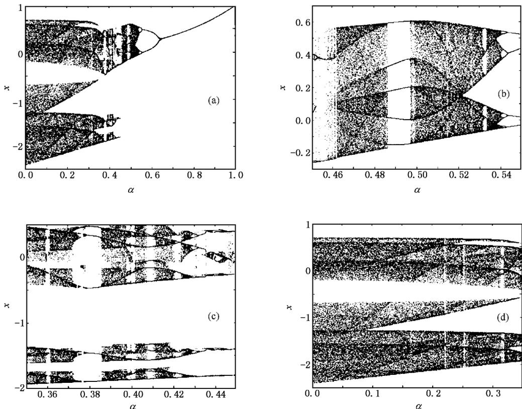
图5 电路随转折值  $\alpha$  变化时的分岔图 (a)  $0 < \alpha \leq 1$  (b)  $0.45 \leq \alpha \leq 0.55$  (c)  $0.35 \leq \alpha \leq 0.45$  (d)  $0 < \alpha \leq 0.35$
