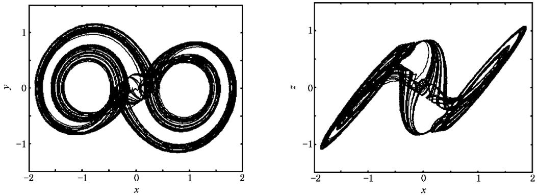
图 10 双层双螺旋混沌吸引子( $\alpha = 0.39$ ,  $\lambda_{\max} = 0.1038$ )
