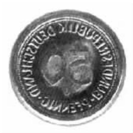
图4 由8mm直径超塑性变形至21mm直径的 $Zr_{41}Ti_{14}Cu_{12.5}Ni_{10}Be_{22.5}$ 非晶样品
