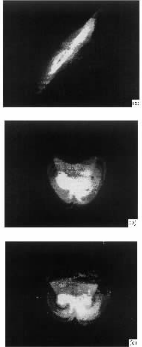
图 3 Chen 氏电路混沌波形 (a) x - y 混沌 (b) x - z 混沌 (c) y - z 混沌
