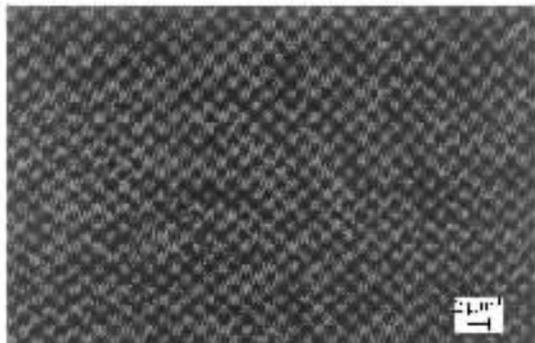
图 7 密闭干燥的 PS 胶体晶体薄膜的 SEM 图
