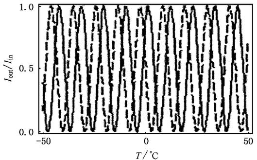
图2  $\theta = 0.01\pi, \varphi = 0.09\pi$  时出射光强与入射光强的比值随温度变化的关系图(实线为半波电压对应的情况,虚线为外加电场为 0 的情况)
