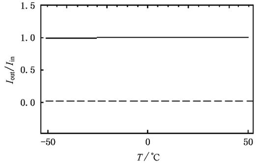
图1  $\theta = 0.229\pi, \varphi = 0.01\pi$  时出射光强与入射光强的比值随温度变化的关系图(实线为半波电压对应的情况,虚线为外加电场为 0 的情况)
