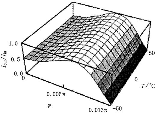
图3 出射光强与入射光强的比值随  $\varphi$  和温度  $T$  的变化关系图 ( $\theta = 0.229\pi$ )
