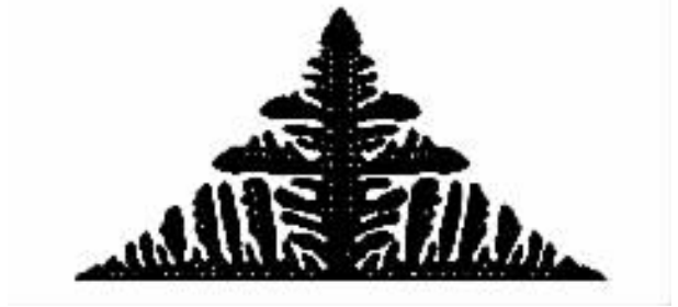
图3 采用 KKS 模型的二维枝晶形貌模拟结果( t = 0.45\text{ms} , T = 890\text{K} )
