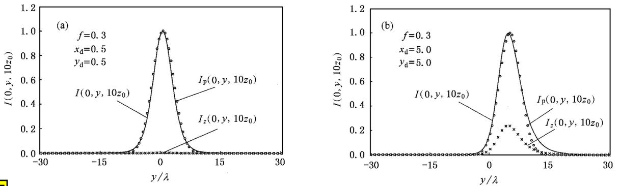
图3 矢量离轴高斯光束在  $z = 10z_0$  面上  $y$  方向的归一化光强分布 (一为用(7)式的计算结果,  $\times \times \times$  为用(7c)式的计算结果,  $\circ \circ \circ$  为用(17)式的计算结果)
