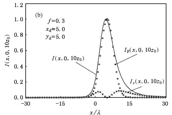
图 2 矢量离轴高斯光束在  $z = 10z_0$  面上  $x$  方向的归一化光强分布 (—为用(7)式的计算结果,  $\times \times \times$  为用(7c)式的计算结果,  $\circ \circ \circ$  为用(17)式的计算结果)
