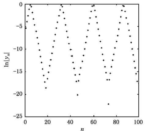
图 4 过焦系统计算机解的演化进程  $\mu = 0.8, x_0 = 0.99999$
