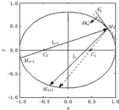
图 9 截断误差使反射线偏离焦点
