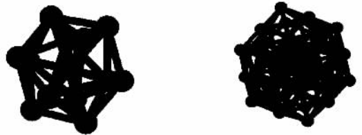
图 2 \text{Cu}_{13} , \text{Cu}_{55} 团簇基态结构 ( T = 200 \text{ K} )
