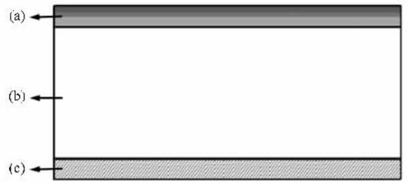
图2 三明治结构的铝导线横界面示意图(a) TiN 或(底部) Ti/TiN(顶部);(b) Al 或 Al 合金;(c) Ti 或 TiN 或(底部) Ti/TiN (顶部)或(底部) Ti/TiN/Ti(顶部)
