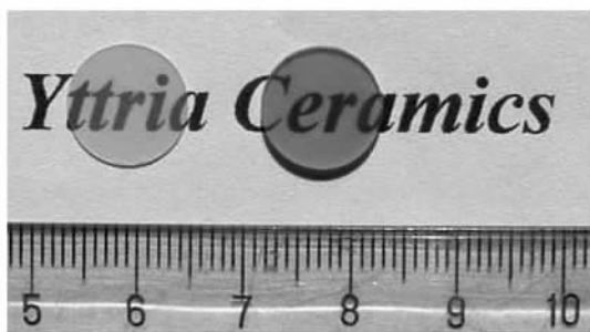
图 1 Nd 3+ :Y 2-2x La 2x O 3 透明陶瓷圆片的照片. 左侧陶瓷片的 Nd 3+ 掺杂量为 1.5at%, 厚度为 0.3 mm. 右侧陶瓷片的 Nd 3+ 掺杂量为 5at%, 厚度为 0.8 mm.
