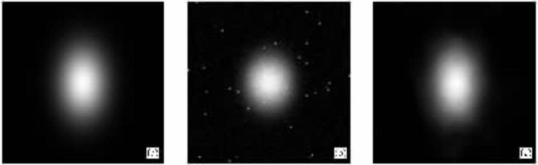
图 3 模拟针孔图像的恢复(  $a = 30$  的高斯焦斑模型 ) ( a )模拟光源 ( b )添加噪声后的模拟针孔图像(  $\text{SNR} = 10$  ) ( c )恢复后的针孔图像
