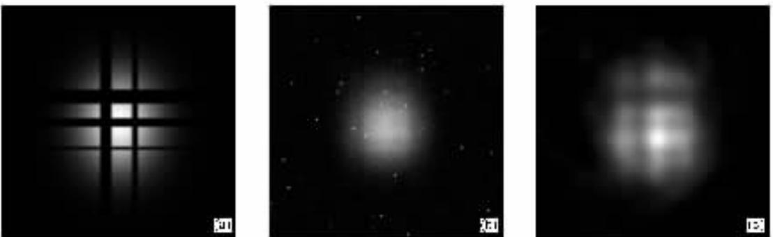
图 5 模拟针孔图像的恢复( 叠加暗线的高斯模型 ) ( a )模拟光源 ( b )添加噪声后的模拟针孔像(  $\text{SNR} = 10$  ) ( c )恢复后的针孔图像
