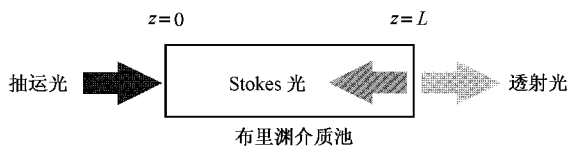
图 1 基于受激布里渊散射的光限幅示意图
