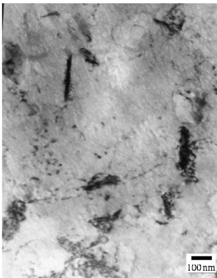
图 7 固溶态的位错组态
