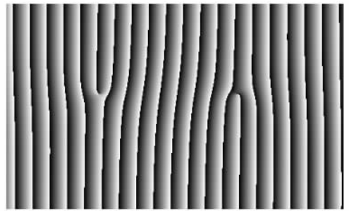
图 1 全息光栅中心区域的局部放大图
