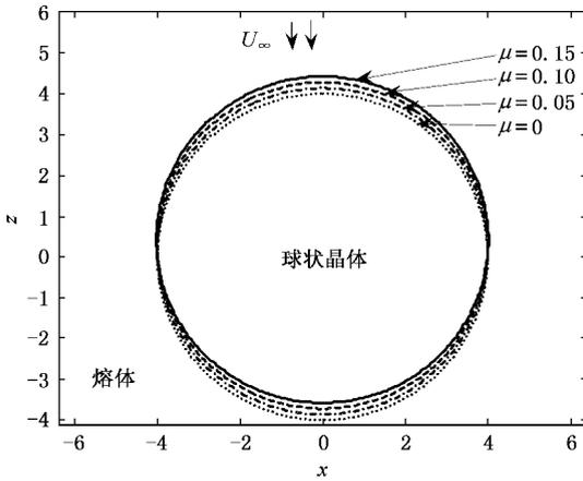
图2 不同强度的远场来流导致过冷熔体中球状晶体的生长
