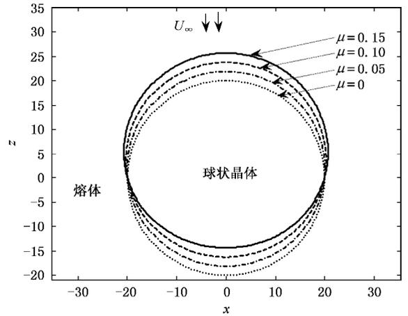
图3 不同强度的远场来流导致过冷熔体中球状晶体的生长
