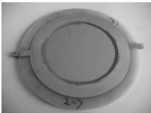
图 1 制作的大面积厚 PIN 探测器(直径 : $\phi 60$  mm,厚度 : $\sim 1000$   $\mu\text{m}$ )
