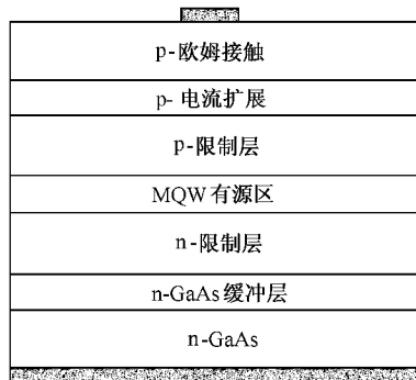
图 1 常规 AlGaInP LED 结构示意图
