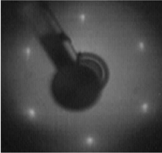
图 1 经过氩刻退火循环处理后得到的清洁 ZnO(0001)面的 LEED 图( E_p = 146 \text{ eV} )
