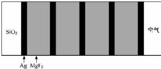
图1 光子晶体的结构
