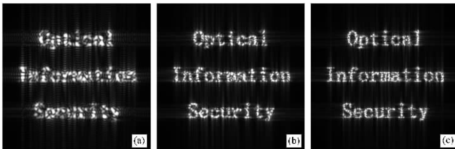
图 5 用恢复的部分密钥解密的结果 (a)用 64 \times 64 的密钥恢复的结果 (b)用 96 \times 96 的密钥恢复的结果 (c)用 128 \times 128 的密钥恢复的结果
