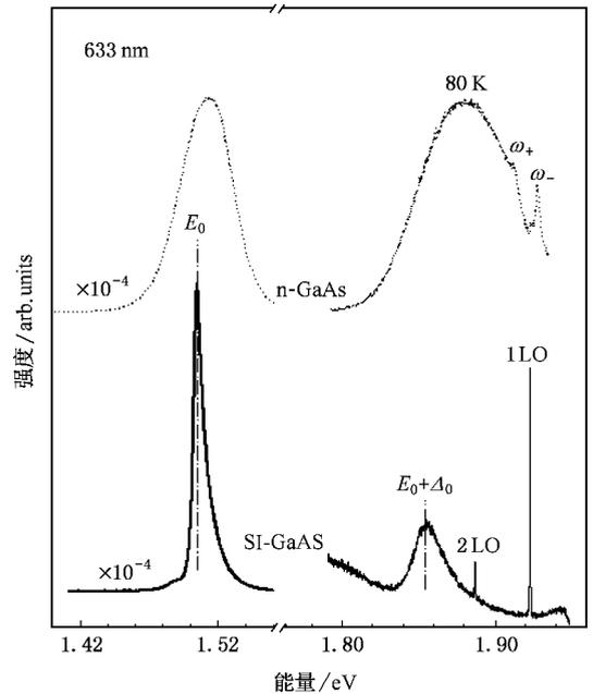
图 1 半绝缘 GaAs 和 n-GaAs 在 77 K 温度下的显微光致发光谱(高能端的两尖峰为 GaAs 的一阶和二阶 LO 声子的拉曼峰.  $\omega_{\pm}$  标出了 n-GaAs 晶体中晶格振动的 LO 声子与等离子激元的耦合模)
