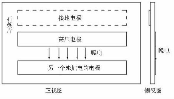
图 5 爬电示意图
