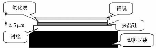
图 1 测试样品纵向结构
