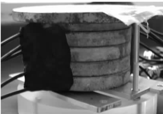
图 2 组装好的 C30 混凝土试样照片
