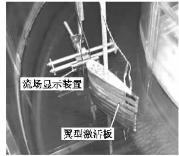
图3 插入翼形体并带有流场显示装置的水槽
