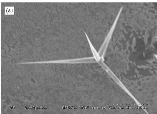
图3 不同硅酸钾浓度的四脚氧化锌 SEM 图片
