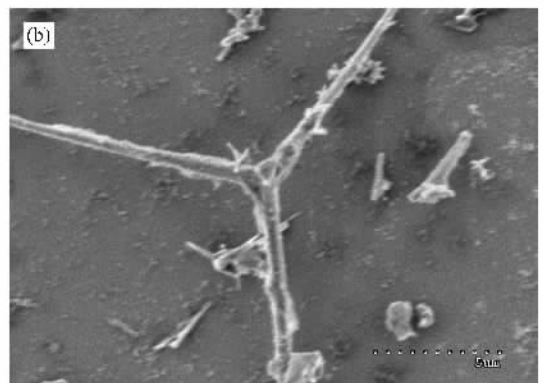
图3 不同硅酸钾浓度的四脚氧化锌 SEM 图片
