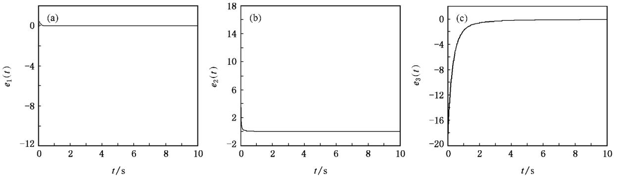
图 8  $a = 0.4, \alpha = 2$  和  $b = -50$  时, 系统 (16) 和系统 (17) 投影同步的误差曲线 (a)  $e_1(t)$  的响应曲线 (b)  $e_2(t)$  的响应曲线 (c)  $e_3(t)$  的响应曲线
