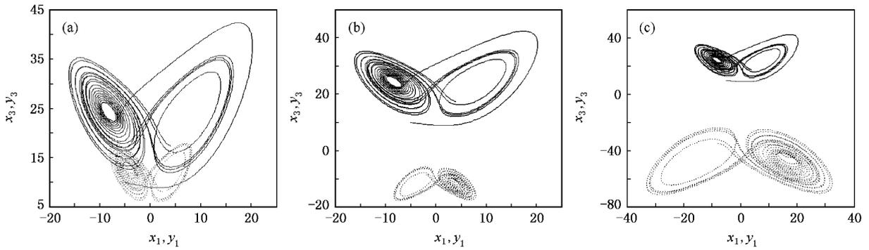
图9  $\alpha$  取不同值时,系统(16)和(17)达到投影同步时的吸引子(实线对应系统(16),虚线对应系统(17)) (a)  $\alpha = 2$  (b)  $\alpha = -2$  (c)  $\alpha = -0.5$
