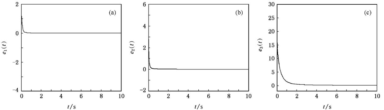
图 6  $a = 0.8$ ,  $\alpha = 2$  和  $b = -20$  时, 系统 (14) 和系统 (15) 投影同步的误差曲线 (a)  $e_1(t)$  的响应曲线 (b)  $e_2(t)$  的响应曲线 (c)  $e_3(t)$  的响应曲线
