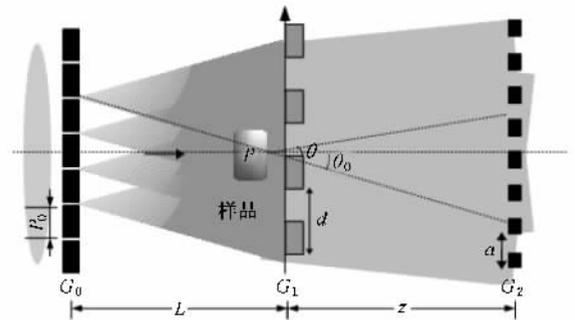
图 1 相位光栅相位衬度成像光路示意图(光栅  $G_0$  是吸收光栅, 光栅  $G_1$  是相位光栅, 周期  $d = 2a$ , 相邻单元的相位差是  $\pi$ . 光栅  $G_2$  是吸收光栅, 周期  $d = a$ )
