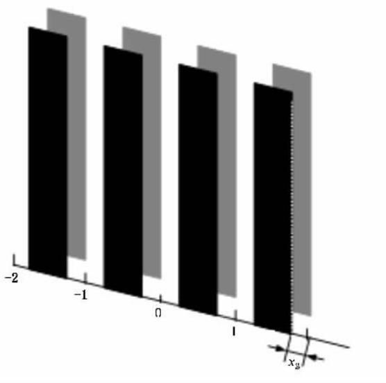
图3 光栅  $G_1$  的像和光栅  $G_2$  的相位位移关系
