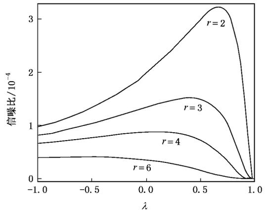
图 3 信噪比作为噪声耦合强度  $\lambda$  的函数随  $r$  的变化  $A = 0.05, Q = 20, E = 0.5, \tau = 1.0$
