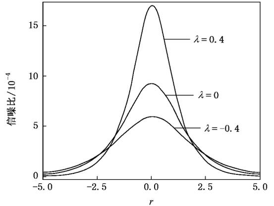
图 6 信噪比作为静态非对称性  $r$  的函数随  $\lambda$  的变化
