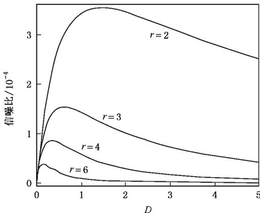
图 1 信噪比作为加性噪声强度  $D$  的函数随  $r$  的变化  $A = 0.05, Q = 20, \lambda = 0.4, \tau = 1.0$
