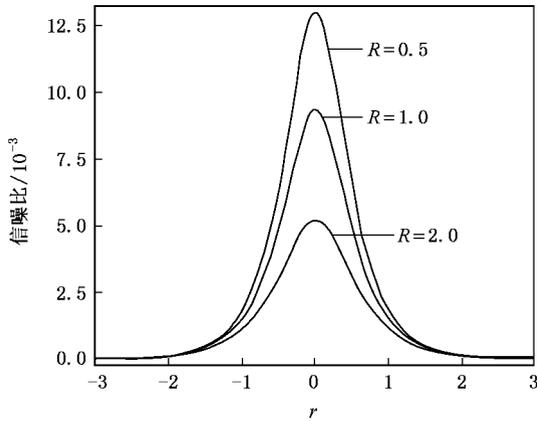
图 4 信噪比作为静态非对称性  $r$  的函数随  $R$  的变化
