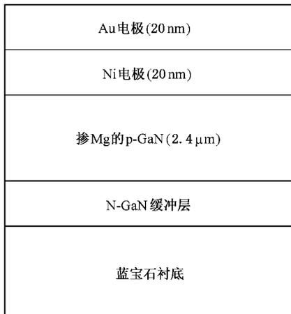
图 1 MOCVD 方法生长掺 Mg 的 p-GaN/Ni/Au 电极结构示意图
