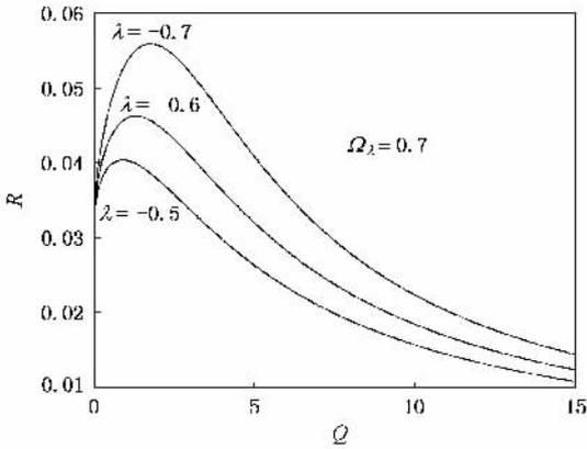
图1  $\lambda$  为负值时的  $R-Q$  曲线  $A=1, \gamma=3, \Omega=3, I_0=1, D=1, \beta=1$
