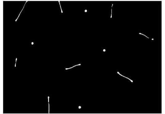
图2 施加硬化脉冲后得到的硬磁畴 \tau_p^h = 1 \mu\text{s} , H_p^h = 2387.3 \text{ A/m} , n_p^h = 200
