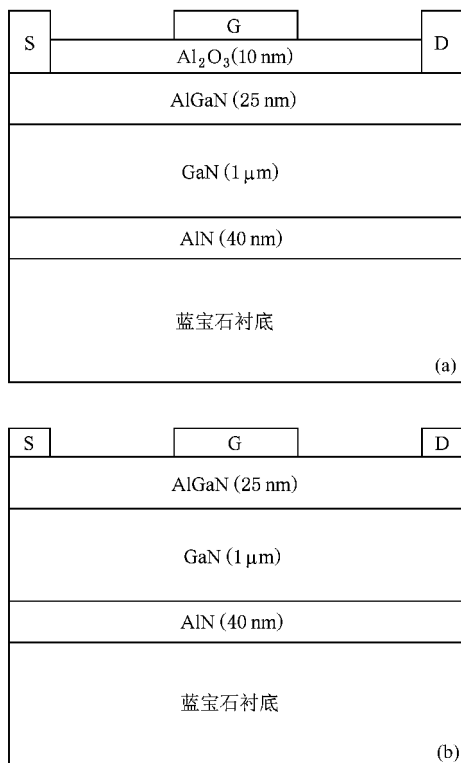
图 1 (a) ALD \text{Al}_2\text{O}_3/\text{AlGaIn}/\text{GaN} MOS-HEMT 器件结构示意图; (b) \text{AlGaIn}/\text{GaN} MES-HEMT 器件结构示意图
