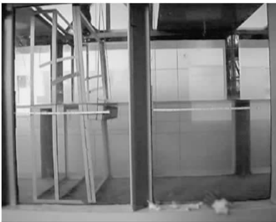
图 1 水中岩石坠落激发表面波的实验水槽
