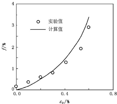
图 5 孔洞体积分数与塑性应变的关系
