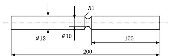
图 3 带切口的圆柱形试件 尺寸单位为 mm
