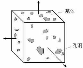
图 1 包含孔洞的材料单元
