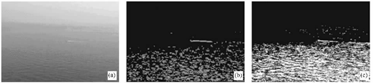
图 5 边缘检测和阈值分割结果 (a) 第 48 帧图像 (b) sobel 边缘检测 (c) otsu 阈值分割
