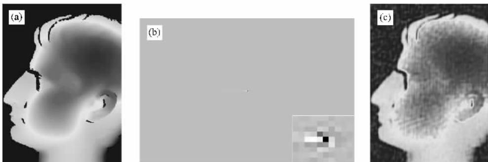
图 3 深度图像的全息图和数字再现结果 (a)深度图像 (b)全息图 (c)数字再现深度图像
